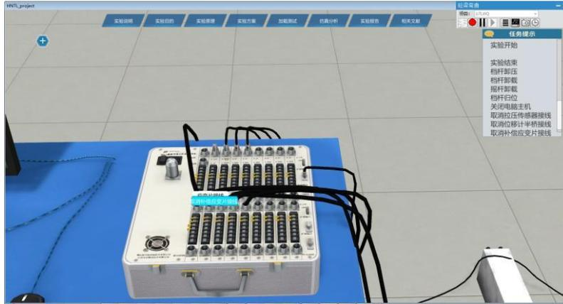
24) 鼠标右键单击数据采集仪下部的9号通道接口，弹框“取消应变片接线”，左键单击“取消应变片接线”，钢筋应变片1接线被取消。依次点击9-12号通道接口，取消钢筋应变片1-4接线。
