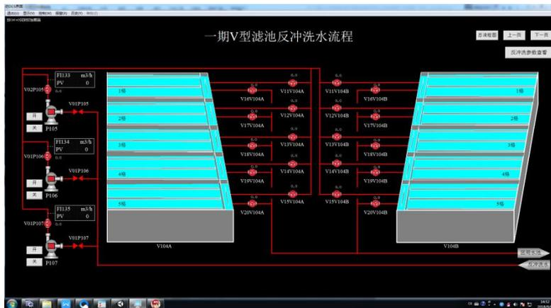
图 20 V 型滤池的反冲洗调控操作
