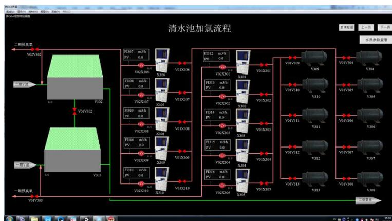
图 18 加氯系统的操控
