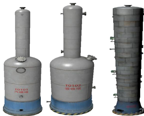
图 7 T0101 汽化塔图 8 T0102 吸收塔图 9 T0103 解析塔
