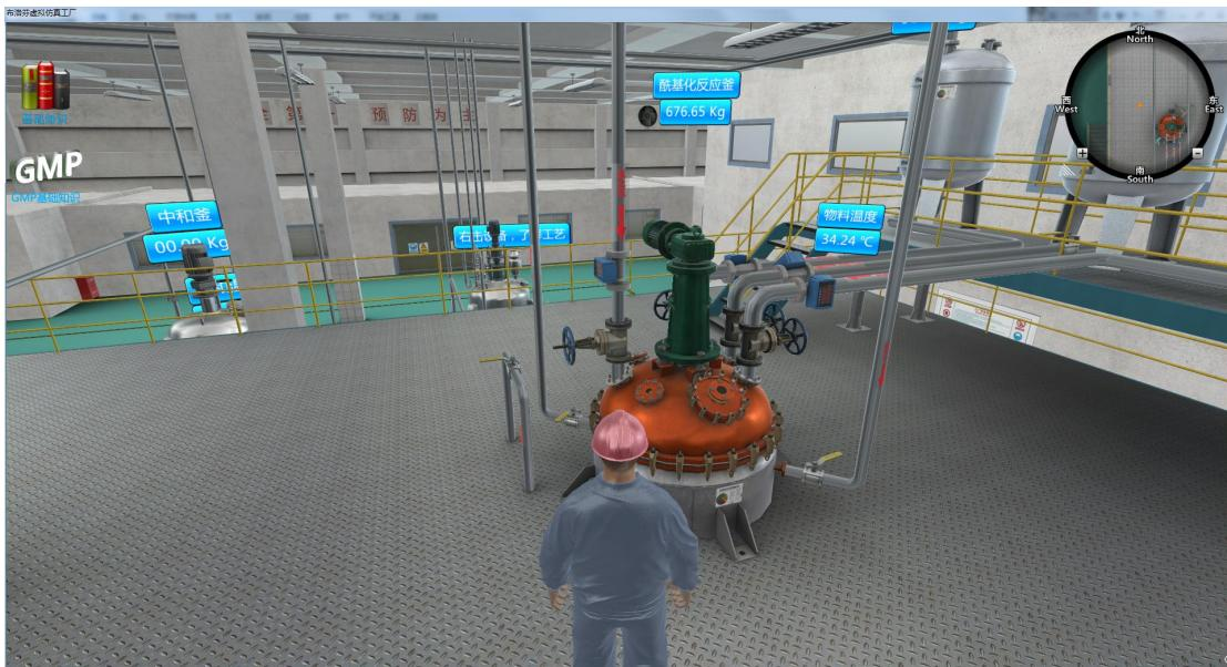
开启平台上水解釜后阀 FA-SJX-09，开度 50。物料输送水解釜。打开阀门 FA-SJX-YS11，釜内加入适量 10% 盐酸，进行水解操作。打开泵前阀 FA-SJX-15，点击水解泵电源，开启离心泵，将水层导入中转釜暂存。水层导毕后，回到平台上开启阀门 FA-SJX-17，关闭阀门 FA-SJX-16，将有机层导入水洗釜浓缩釜中。开启阀门 FA-SJX-21，加水洗至 pH 为 6 时，关闭阀门。开启蒸汽进气阀 FA-SJX-PS20，有机层加热到 82℃ 蒸馏出石油醚。
