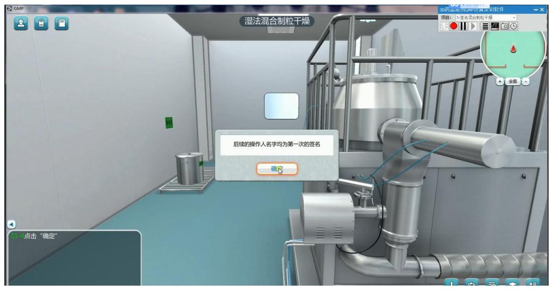
到沸腾干燥间开始生产操作。检查确认沸腾干燥机主塔物料已转入。启动沸腾干燥机，并将排风机频率设定为30Hz，电加热温度设定为85℃。生产过程中对物料的干燥程度进行取样检测。停止干燥，关闭加热。停机出料。打开容器密封，准备出料。拉动料车出料。检查并确认批生产记录填写完毕后传递至下一工序。
