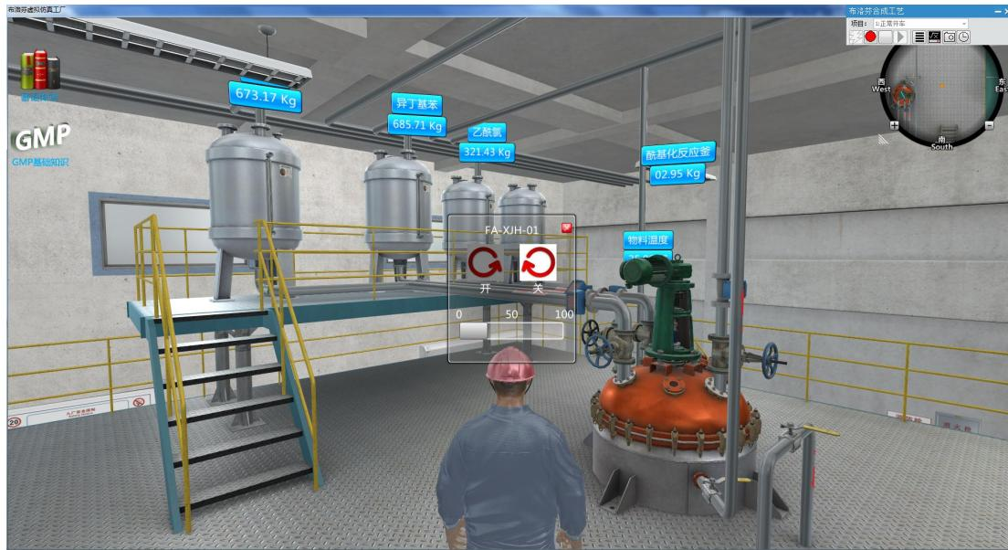
走上平台，打开阀门 FA-XJH-01，将计量好的石油醚加入带保护的搪瓷反应釜内，搅拌降温，请注意加入量。开启搪瓷反应釜搅拌器，搅拌降温。
