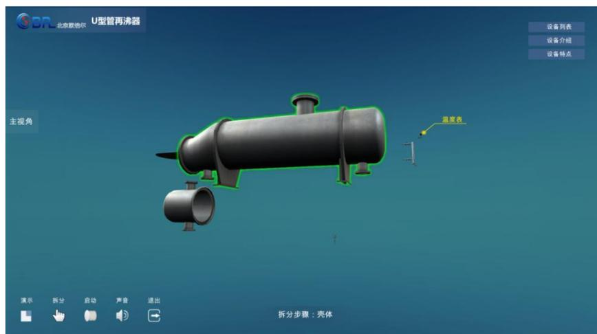
图 12 U 型管再沸器手动拆分
