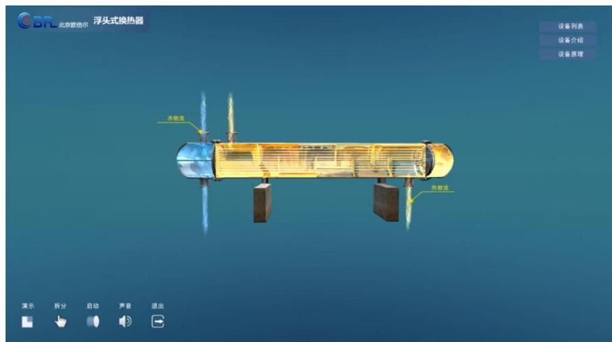
图 17 浮头式换热器原理演示
