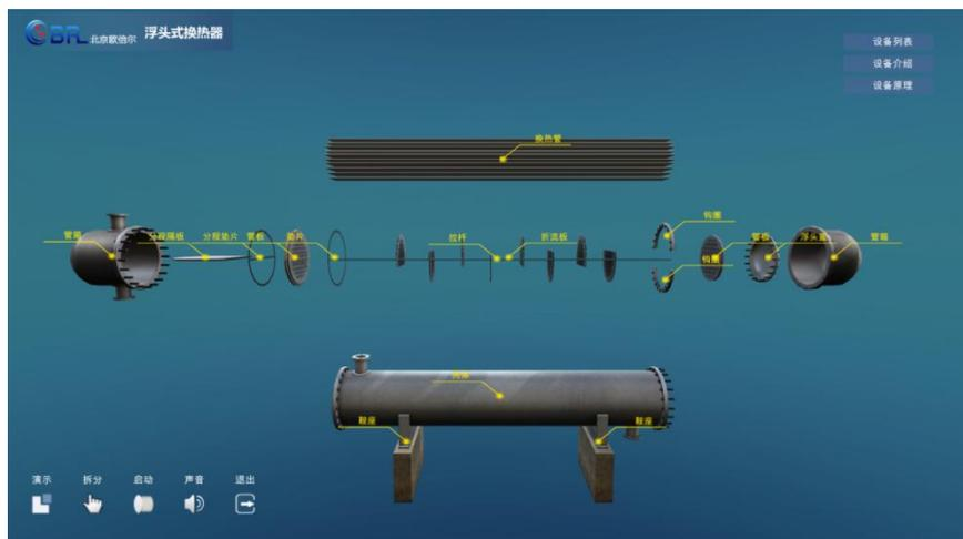
图 15 浮头式换热器内部结构介绍
