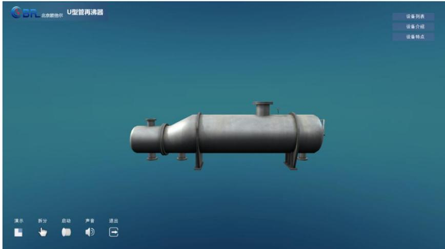
图 10 U 型管再沸器整体结构
