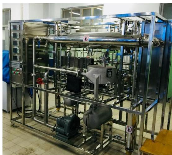
换热器拆装仿真实验设备包括：固定管板式换热器、浮头式换热器、U型管再沸器（三维模型），有设备内部零部件 3D 模型和换热器工作过程演示。
