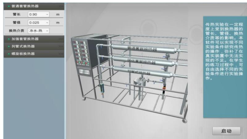
图 20 换热介质为冷水-热水仿真流程图
