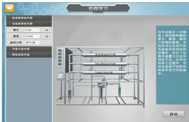
图 19 换热介质为空气-热空气仿真流程图
