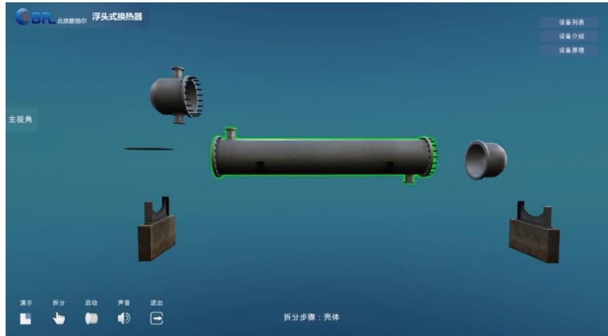
图 16 浮头式换热器手动拆分
