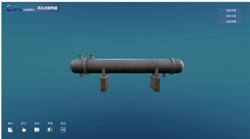
图 14 浮头式换热器整体结构
